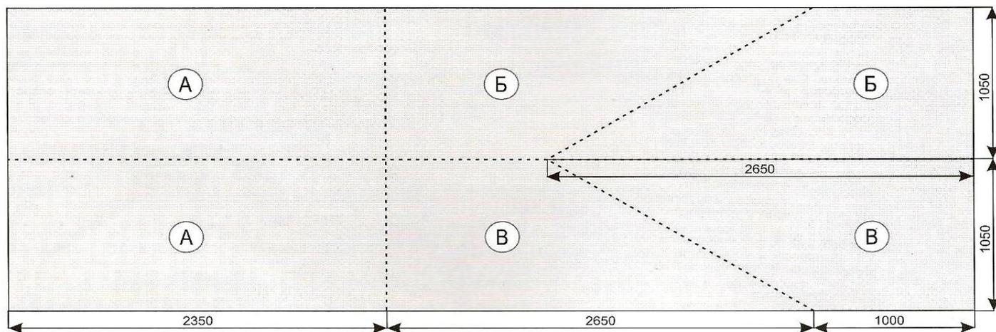
Разметьте лист согласно рисунку. Затем ровно по линиям разрежьте сотовый поликарбонат при помощи монтажного ножа или другого инструмента. Защитную пленку во время данной операции снимать не надо. Пометьте листы с наружной стороны маркером.
